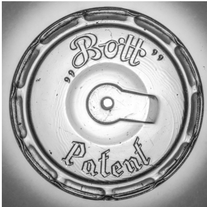
Bild 31: Konservglasdeckel System "Bott" (nach DRP 400988 vom 01.12.1922)
